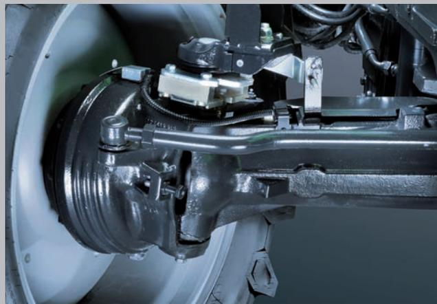
Un concept de sécurité unique conçu par DEUTZ-FAHR. Freins à disque séparés refroidis à l'huile sur le pont avant.
