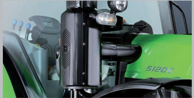
Catalyseur d'oxydation diesel (DOC) de pointe en Stage IIIB ou réduction catalytique sélective (SCR) pour la technologie d'échappement Stage IV.
