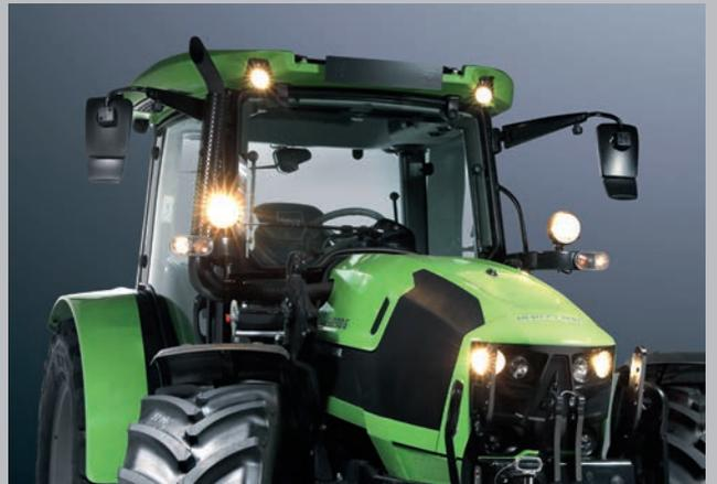
Pour une visibilité optimale en cas de mauvaises conditions météorologiques. Six phares de travail sur le toit et les montants latéraux. Deux phares de travail sur le capot.
