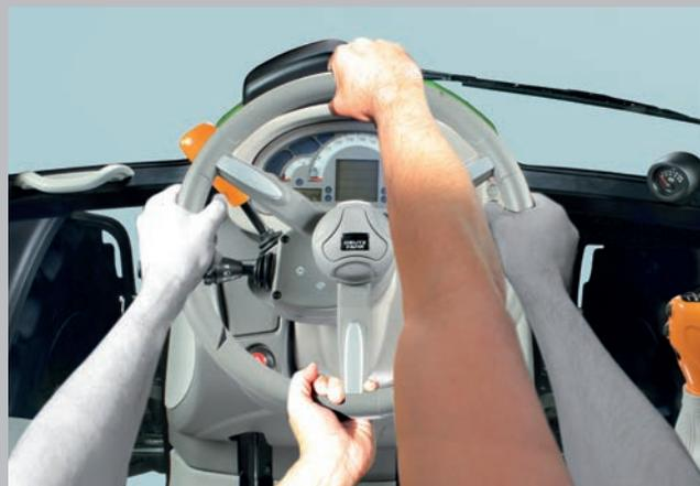
Système de direction rapide SDD. Rotations du volant divisées par deux, puissance de direction doublée.
