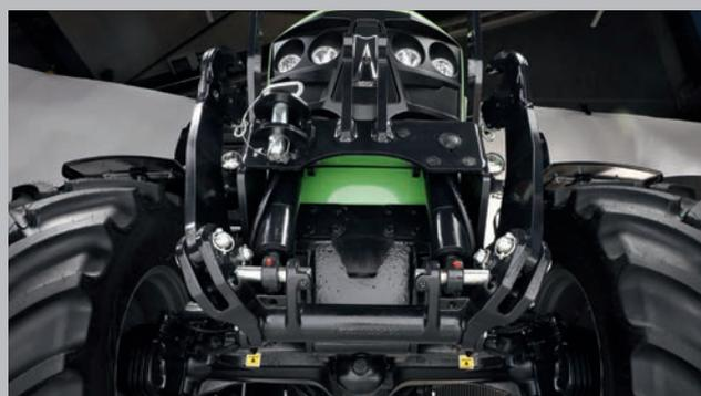
Relevage avant et PDF. Capacité de relevage de 2 100 kg et PDF 1 000.
