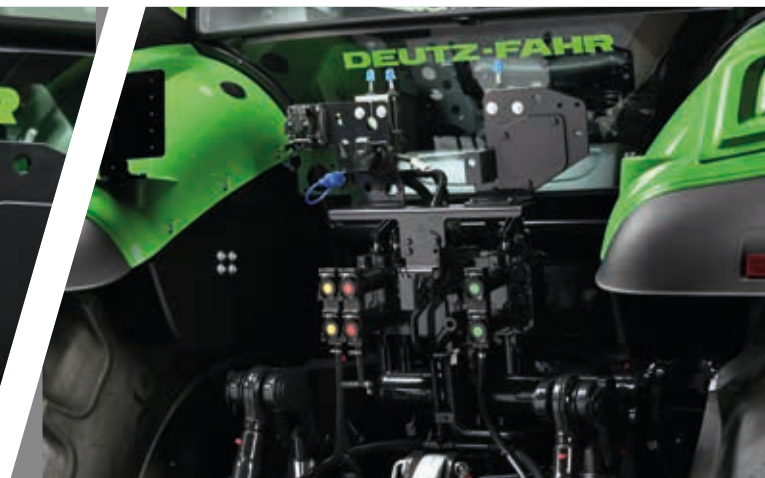
> Zone de fixation arrière avec trois valves mécaniques.
