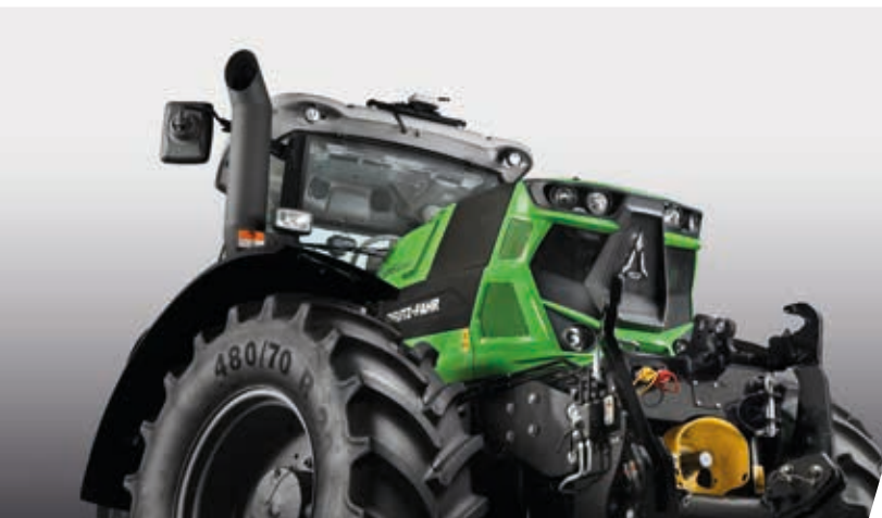
> Relevage avant d'une capacité de relevage de 3 850 kg et PDF avant 1 000 en option.
