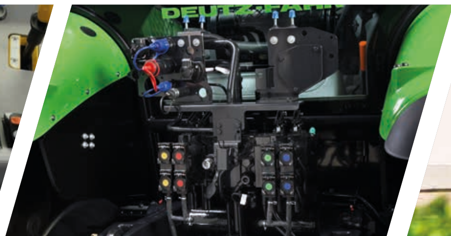
> Zone de fixation arrière avec quatre valves mécaniques et coupleurs Power Beyond.
