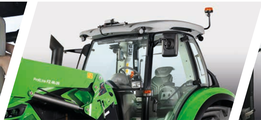
> Le récepteur précis SR20 monté sur le toit de la cabine.
