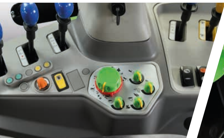
> Quatre monoleviers ergonomiques et facilement accessibles pour l'actionnement des valves hydrauliques à commande mécanique.
