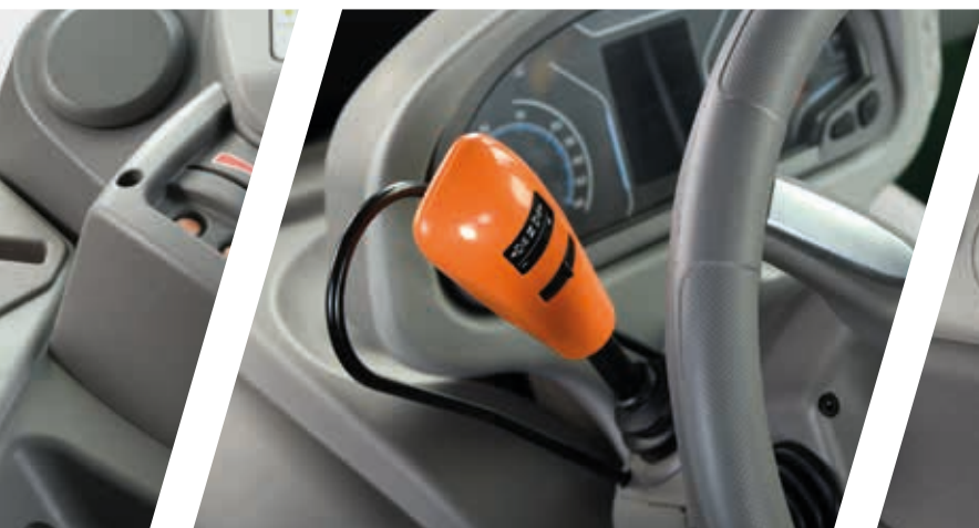
> Levier d'inverseur hydraulique ergonomique avec molette de réglage SenseClutch.
