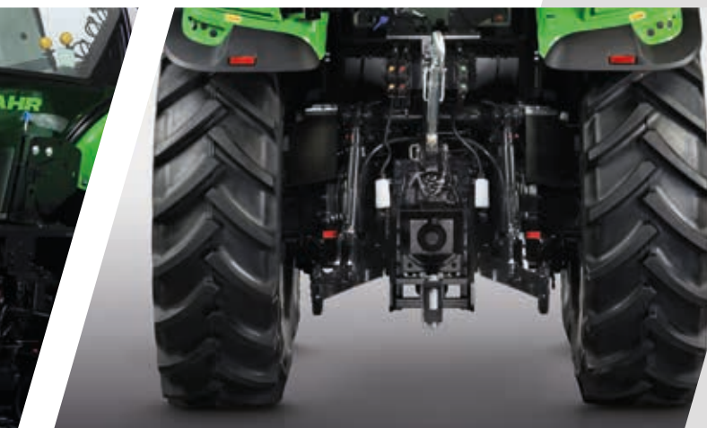
> Capacité de relevage arrière jusqu'à 9 700 kg.
