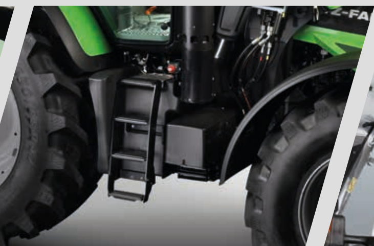
> L'interrupteur principal de la batterie et le compartiment de la batterie se trouvent sur le côté droit du tracteur.
