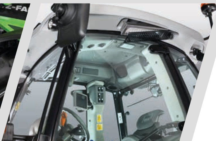
> Les filtres à air de la cabine sont facilement accessibles sous le toit.
