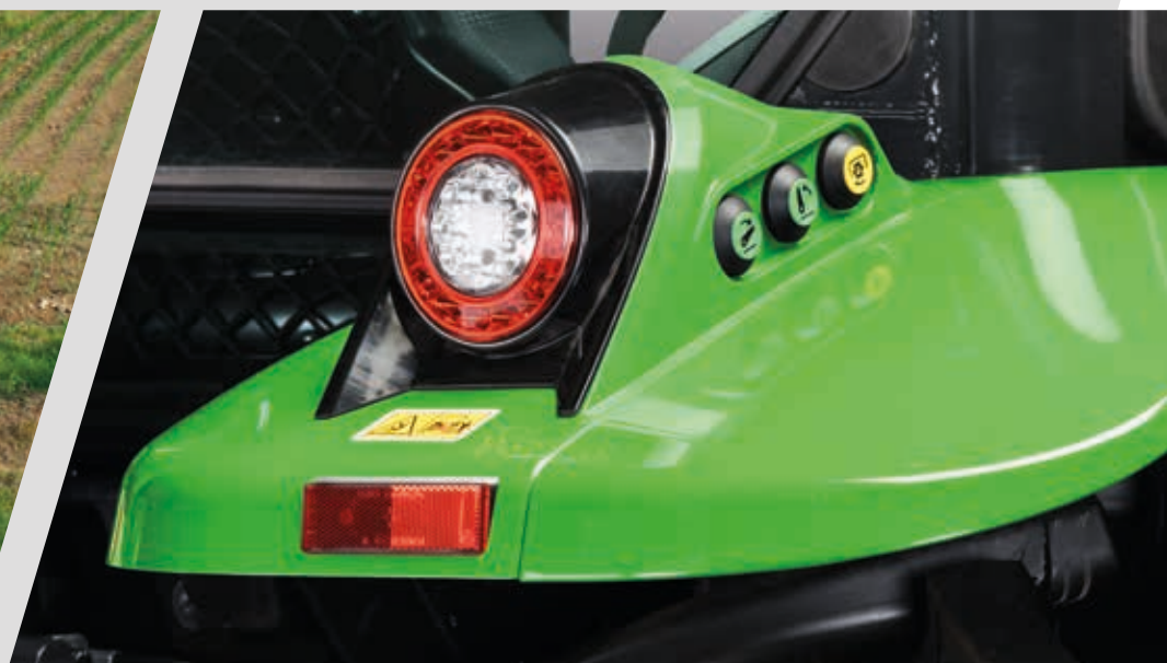
> Commandes extérieures de la PDF et du relevage arrière.
