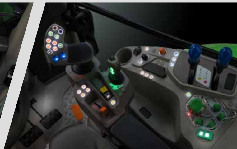
> Le fameux joystick MaxCom qui équipe les versions TTV est un concentré de haute technologie qui permet au conducteur de contrôler d'une seule main toutes les fonctions principales de la machine dans le confort total.
