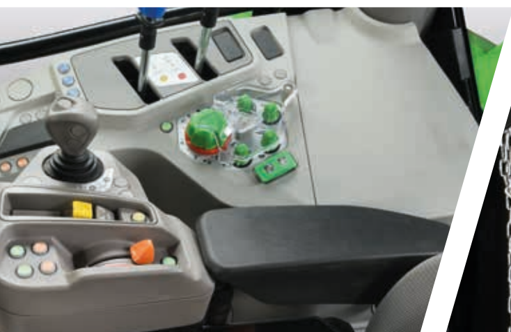
> Commandes mécaniques et électrohydrauliques.
