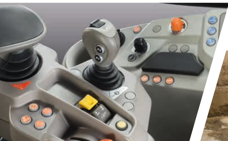
> Assurant non seulement un contrôle simple et sûr du relevage, les joysticks programmables installés en usine à côté du siège du conducteur sont, sur le plan ergonomique, nettement supérieurs à toute solution du marché de deuxième monte.
