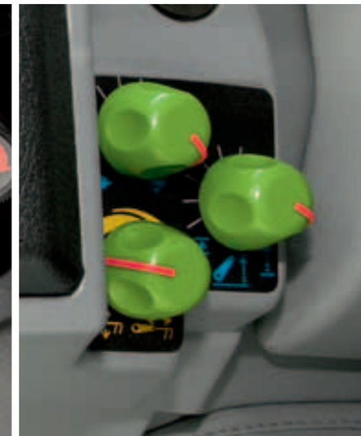
Le relevage électronique peut être réglé rapidement et en toute simplicité à l'aide de potentiomètres.
