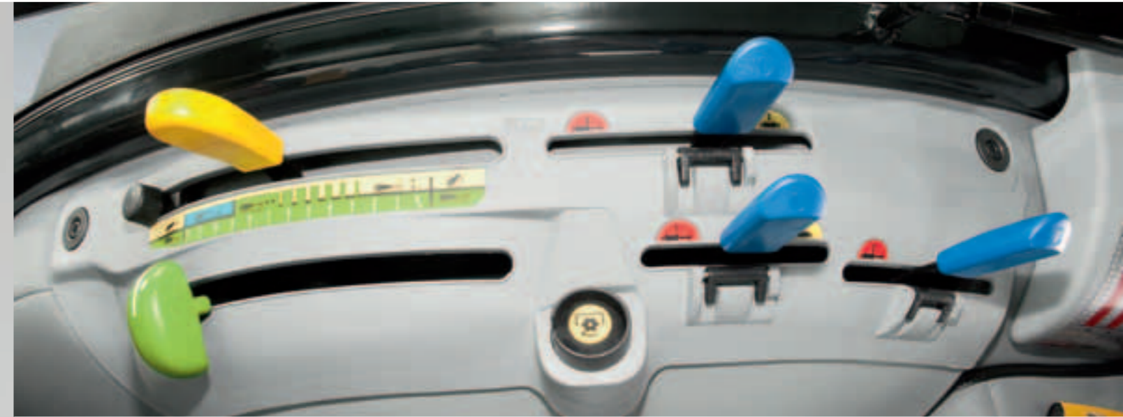
La commande mécanique de relevage assure beaucoup de confort au travail.
