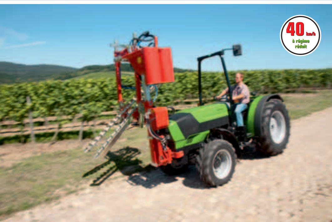
La boîte Overspeed permet aux Agropius V/S/F de rouler à 40 km/h à régime moteur économique.
