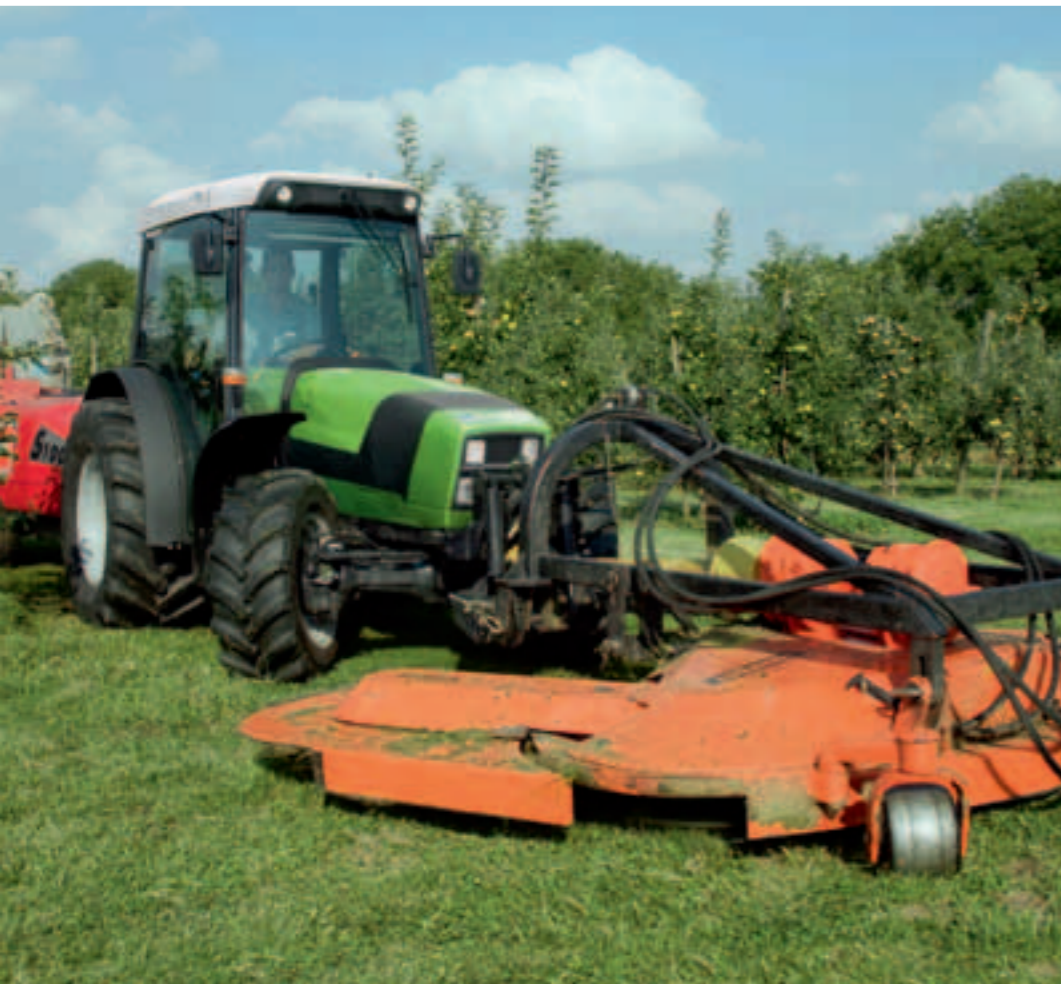
Les quatre points d'attelage des outils permettent de travailler avec précision dans les vergers.
