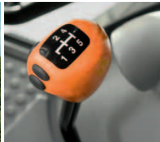
Les rapports Powershift s'enclenchent aisément en appuyant sur un bouton du levier de vitesses.
