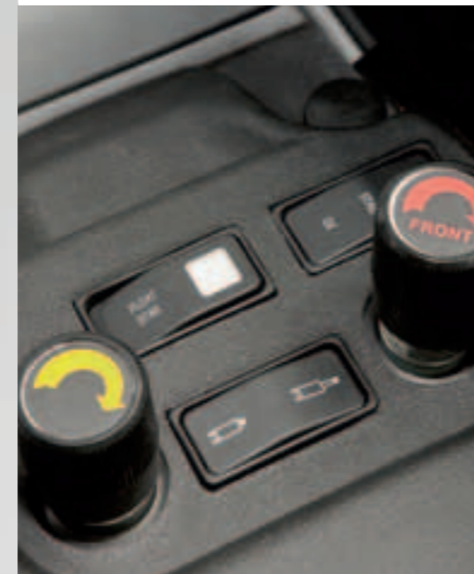
Stabilisateurs et chandelle à commande électrohydraulique et régulateurs de débit pour les outils supplémentaires.
